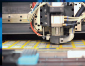
LE SHEET™是细微化布线图的钻孔加工用辅助材料。
