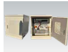
直接甲醇燃料电池（DMFC）是以甲醇和空气为原料直接生成电力。由于是化学反应发电，噪音低，不产生大气污染物质。用于通信设备等的时间（72小时以上）备份电源。
